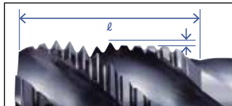
JIS 规格全长 JIS standard overall length
