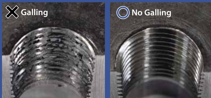
加工 SS400 的照片 Image to process taper pipe thread in SS400 material
